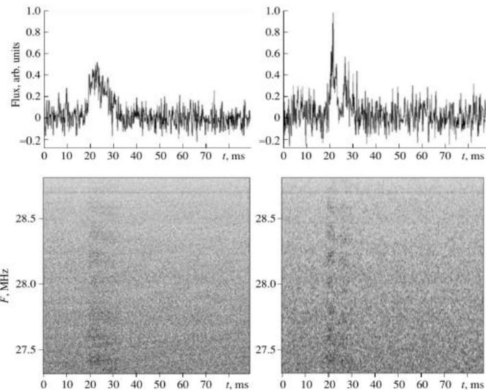
Рис. 1. Постдетекторний метод компенсації впливу дисперсійної затримки (ліва панель) та когерентний метод компенсації дисперсійної затримки (права панель). Обидва методи були застосовані для відтворення форми одного й того ж імпульсу PSR B0950+08.
