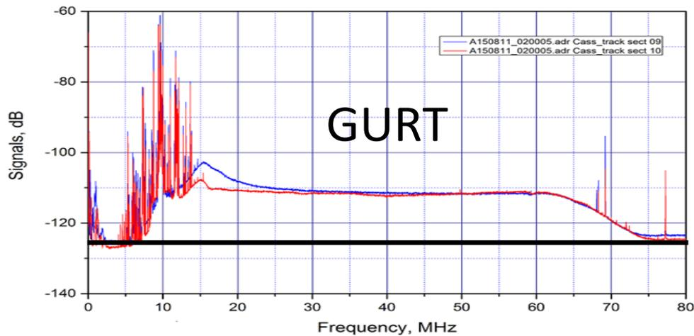
Рис. 7. АЧХ-секции ГУРТ с эквалайзерами и контурным корректором
