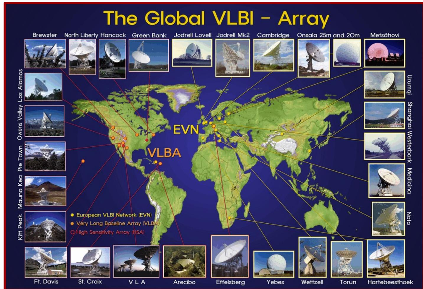
Tecnica che consente di mettere in correlazione i dati raccolti da vari radiotelescopi che osservano simultaneamente una sorgente radio, combinandoli in modo da ottenere un'immagine di risoluzione tanto più elevata quanto più è ampia la distanza tra le antenne.
