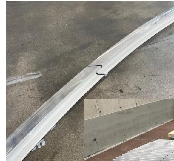
Giunzione scorretta settori rotaia
