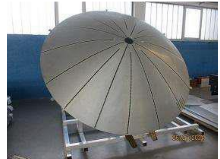
Specchio secondario a seguito della lavorazione su macchina CNC
