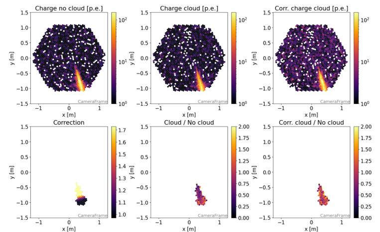
Figure 2: Light attenuation correction ( $h=7$  km,  $T=0.6$  cloud) [4].
