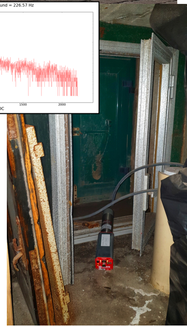
misura di fondo ambientale alla finestra (~230 Hz)
