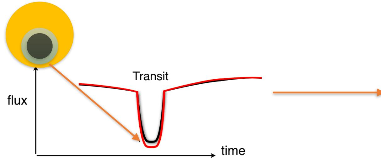
$$\text{Transit depth} = \frac{\Delta F_\lambda}{F_\lambda} = \frac{F_\lambda^{\text{out}} - F_\lambda^{\text{in}}}{F_\lambda^{\text{out}}}$$
