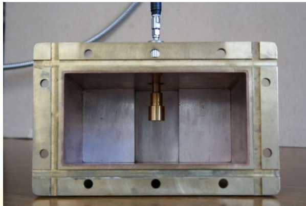
Transizione guida circolare – rettangolare per la calibrazione del ricevitore.
