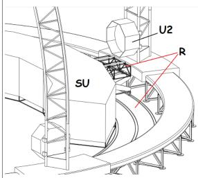
SU indica la struttura Support Unit, in pratica Integration and Maintenance Hall per le unità secondarie, in grado di ospitarne un certo numero e dove vengono svolte le attività di integrazione degli strumenti, che vengono spostati in SU insieme all'unità di supporto per mezzo dell'unità di movimentazione **R**. **OU** (fig. precedente) indica i locali dedicati alla residenza ed al controllo. Le unità Ux sono standardizzate in termini di interfaccia verso gli
