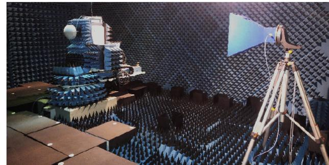
*GNSS ANTENNA GROUP DELAY CHARACTERIZATION VERSUS AZIMUTH AND ELEVATION, INSIDE ANECHOIC CHAMBER.*
