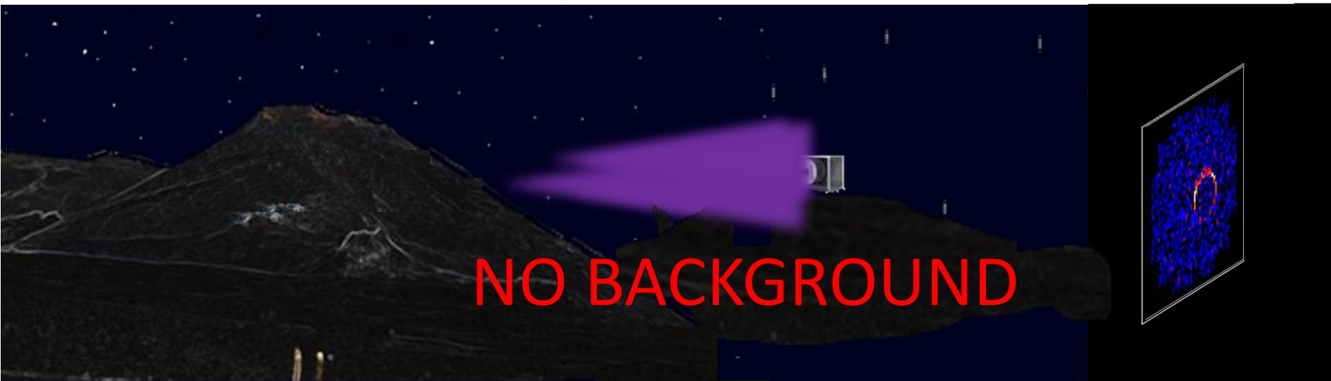
Poiché i muoni interagiscono molto poco con la materia, possono attraversare gran parte della struttura rocciosa, perdendo una frazione di energia proporzionalmente allo spessore delle rocce attraversate. La distribuzione della densità dell'interno di un vulcano, per esempio, può essere determinata misurando l'attenuazione differenziale del flusso muonico in funzione della quantità di rocce attraversate lungo direzioni diverse.
