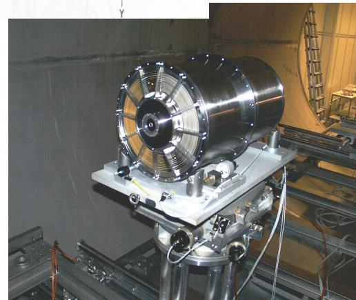
Ottica Wolter I multi-shell sviluppata da Citterio et al. Per Swift con sostegno di ASI e INAF.
