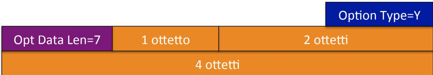
L'**Hop-by-Hop** e il **Destination Options** header hanno la stessa struttura, il primo identificato da uno **0** nel Next Header dell'IPv6 header, il secondo dal valore **60**.
